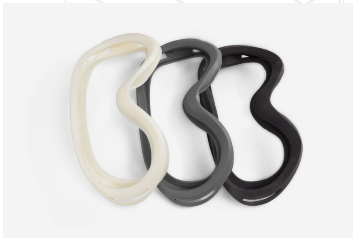
Figura 5: Prototipi di maschere da sci realizzate con FDM, SLA e SLS (partendo da sinistra) [8]
