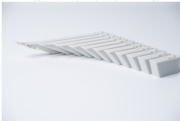
Figure 51: Effetto di un aumento dell'angolo di sbalzo (incremento di 5 gradi) sulla qualità di stampa. L'ampiezza massima raffigurata è di 70 gradi [75]
