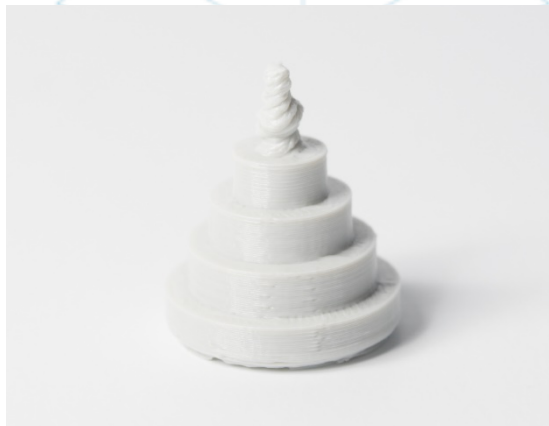
Figura 53: Prototipo di perno cilindrico filettato con diametro decrescente (da 25 a 5mm) con estremità superiore troppo piccola per la stampa. [77]
